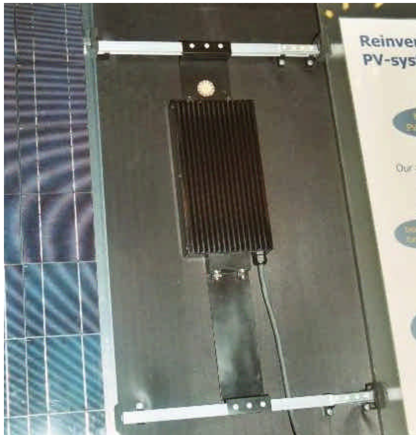
Figuur 3.5.2. Dummy inverter voor PV-wireless, zoals gepresenteerd op conferentie PV for Europe, 7-10 oktober 2002, Rome
